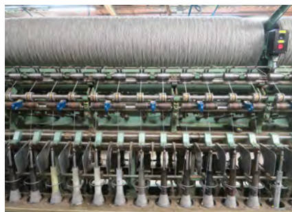
Kuvat 30 ja 31. Kierrätyslangan kehruuta Pirtin Kehräämöllä.
