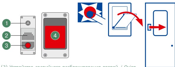
(3) Устройство аварийного разблокирования дверей / Ovien avaaminen hätätilanteessa / Door release and opening board
